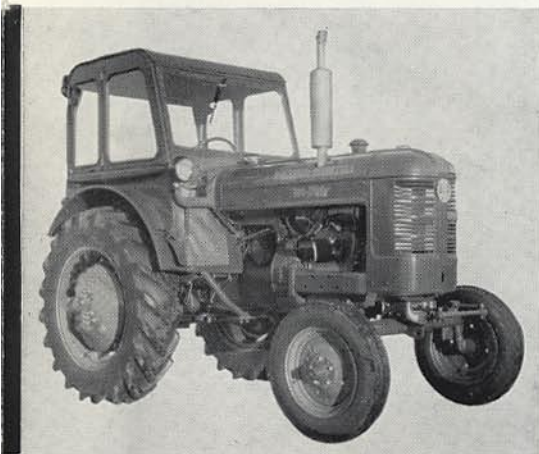
Skyddsramen är så konstruerad att den lätt kan kompletteras till en hytt.
